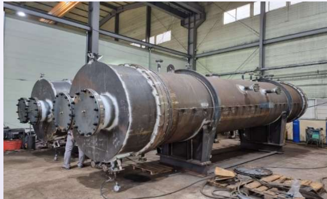
포스코 Sulphur Condenser
