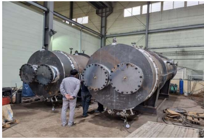
포스코 Sulphur Condenser
